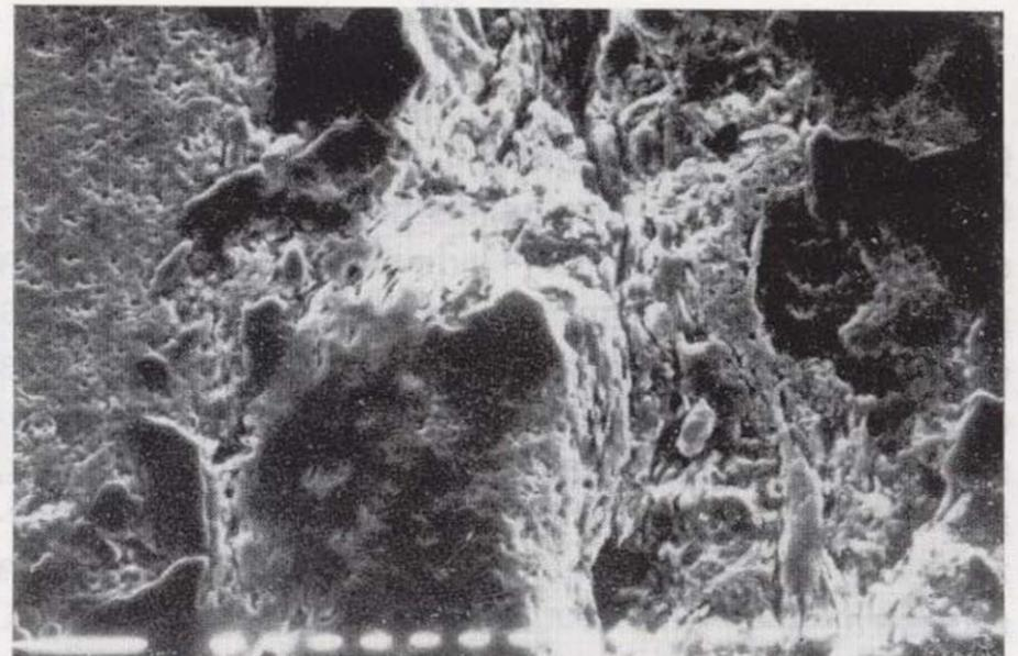
Figura 9.—Muestra 2. Detalle de una fisura, marcada por la orientación de los filosilicatos en sus bordes, también se observan algunos granos de cuarzo, sin poros, y otros granos microporosos. (MEB,  $\times 320$ , 1 marcador =  $10 \mu\text{m}$ ).
